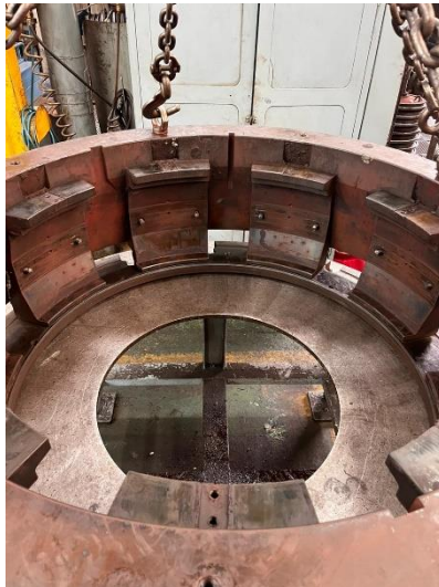
Junção da banda de rodagem
